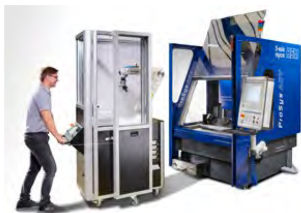
Prinzip des Andockens an eine Fräsmaschine
