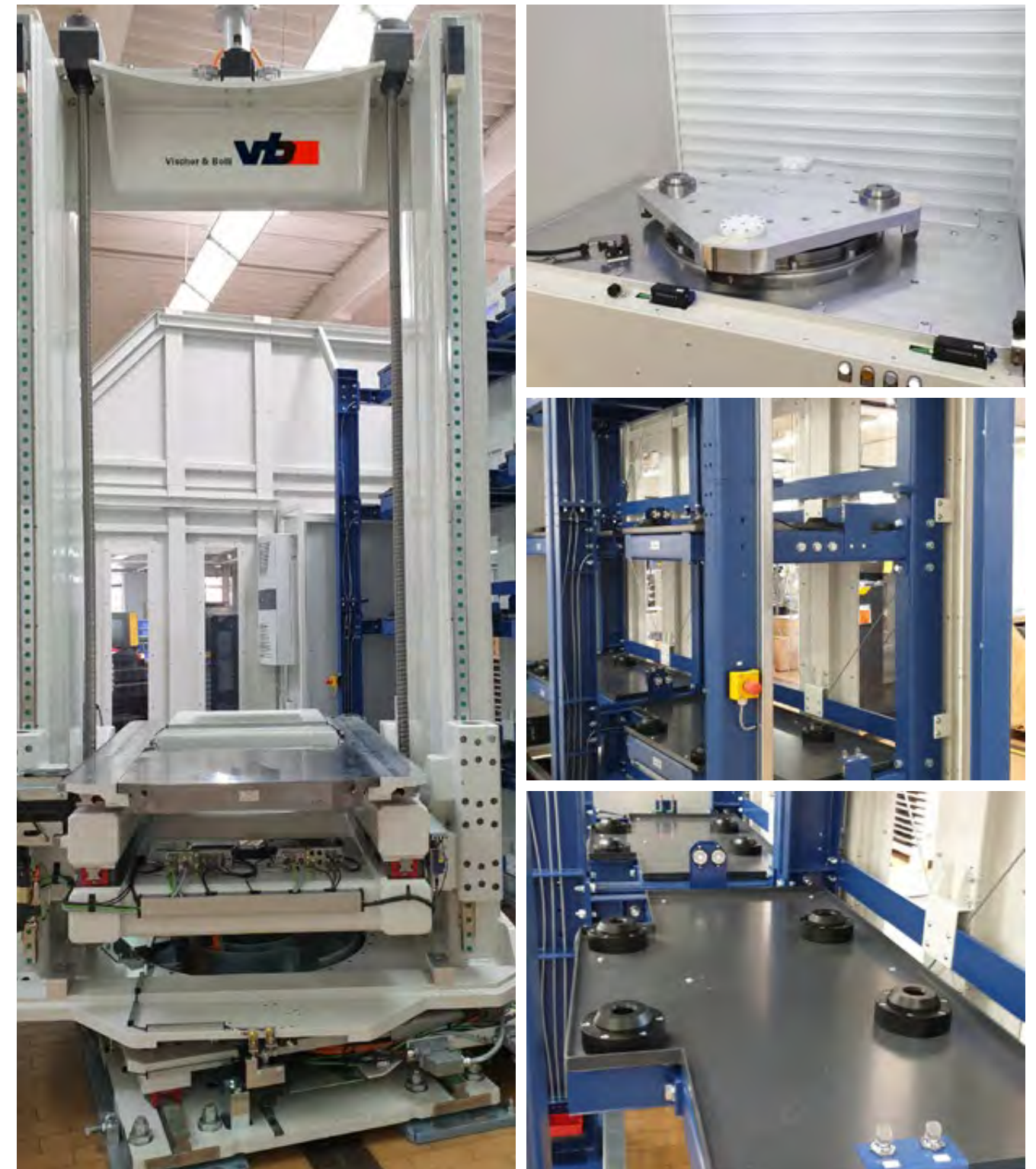
Praxisbilder Schwerlasthandling, Fahrwagen und Rüstplatz beide 360° drehbar
