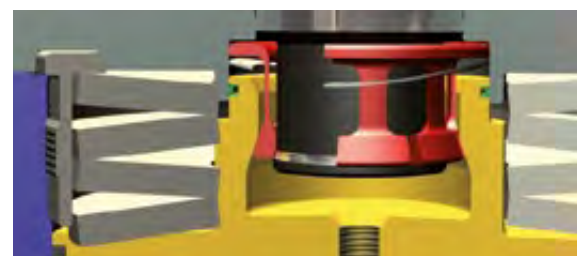
Höchste Einzugs- und Haltekraft dank hydraulisch beaufschlagten Tellerfedern: mechanisch spannen – hydraulisch lösen
