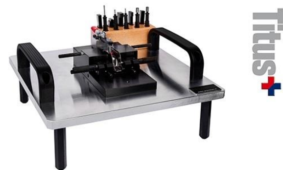
Prüfvorrichtung Möbelscharnier (Titus d.o.o.)
