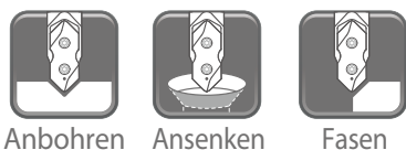
Anbohren Ansenken Fasen
